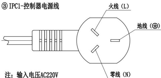
注：输入电压AC220V
