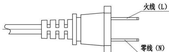
注：输入电压AC220V
