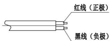
注：输入电压DC24V
