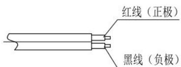
注：输入电压DC12V/DC24V
