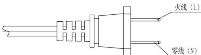
注：输入电压AC220V
